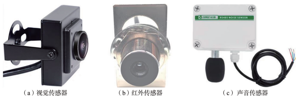
图5 牛排智能烹饪系统中的传感器硬件设备
